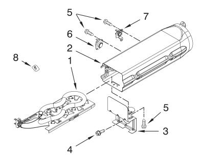
**DRYER HEATING PARTS - GAS**
